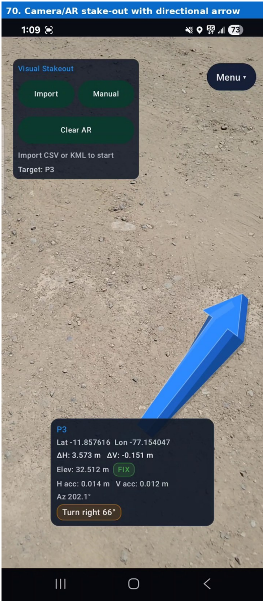
Figura 70. Replanteo con cámara/AR y flecha direccional.
