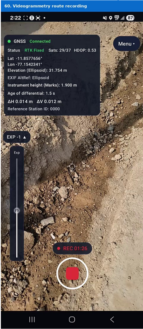
Figura 62. Recorrido videogramétrico para extracción posterior de frames.
