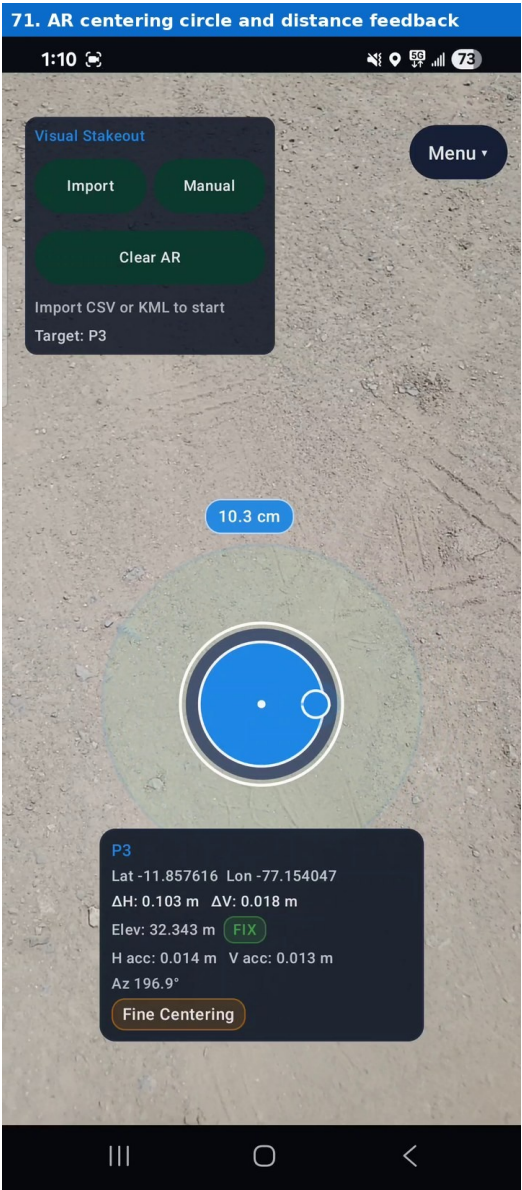
Figura 71. Círculo de centrado y retroalimentación de distancia.
