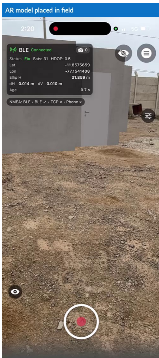
Figura 71. Modelo georreferenciado colocado en campo.
